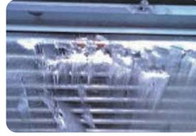
熱交換器表面の損傷
